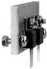
Placez deux vis à tête ronde M3x10 et deux écrous sur les radiateurs. Insérez les régulateurs sur le circuit imprimé. Ne soudez pas encore.
