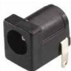
Implantez le connecteur CN1a. Celui-ci doit être fermement plaqué contre le circuit imprimé. Replier les pattes vers l'extérieur, après insertion, pour augmenter la rigidité puis soudez.
