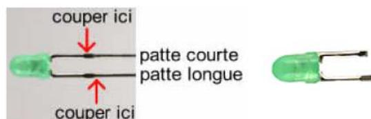
Puis insérez la première LED verte sur le circuit imprimé, patte longue (anode) en haut, côté composants. Vérifiez que la patte est parfaitement parallèle à la pastille. Soudez l'anode mais laissez la cathode libre pour le moment. La position reste facilement ajustable tant qu'une des pattes n'est pas soudée.
