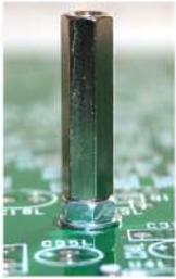
Chaque vu-mètre repose sur 2 entretoises qui sont constituées d'une vis M3x12mm insérée par la face inférieure du circuit, d'une rondelle métallique, d'un écrou M3 puis d'une entretoise de 20mm. Deux vis M3x6mm maintiennent le vu-mètre. Brancher le connecteur des vu-mètres sur CN4L (gauche) et CN4R (droite).
