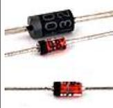
Implantez D8. Utilisez une loupe pour en vérifier le nom (1N914) et la différencier des diodes Zener D1 à D4.
