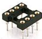
Insérez et soudez les 5 supports de C1 à 8 pins.
